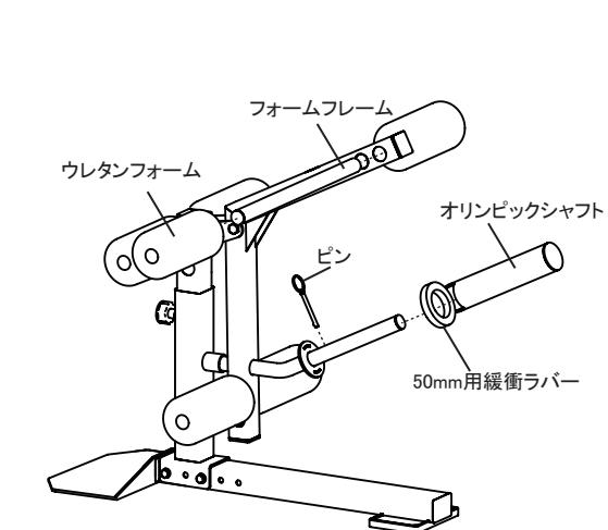
メインフレーム、高さ調節フレームにウレタンフォームを接続します。その後、オリンピックシャフトをメインフレームに固定します。
