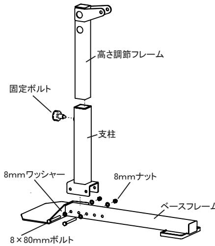
支柱とベースフレームを接続します。その後支柱に高さ調節フレームを差し込み固定します。
