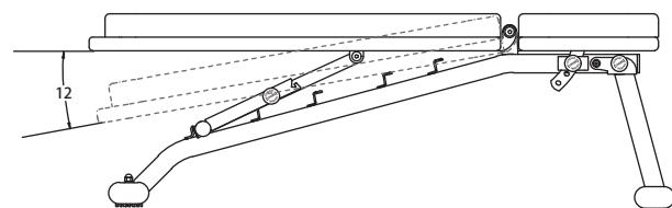
サポートプレートをアジャストフレームに戻し、アジャストフレームの調整用ノブを持ちながら、シートを倒します。この時調整用ノブが端の角度調整フックに引っかかるようにしてください。
