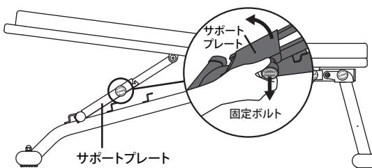
②背もたれ側のシートを起こしたまま、サポートプレートの固定ボルトを手前に引っ張り、矢印の向きにサポートプレートを起こします。
